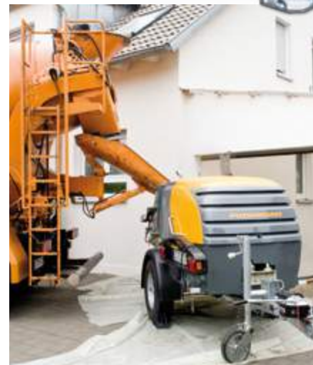
Les bétonnières portées ont un accès optimal à la grande trémie.
